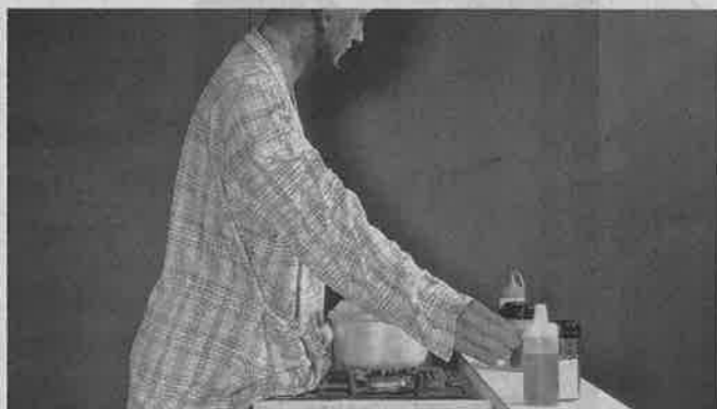
服がガスこんろの火に触れて着火する様子 (製品評価技術基盤機構提供)
